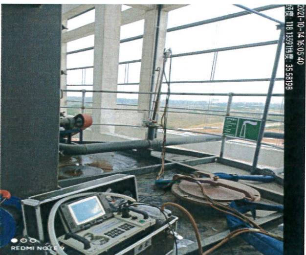
附图 3 水泥仓废气采样
